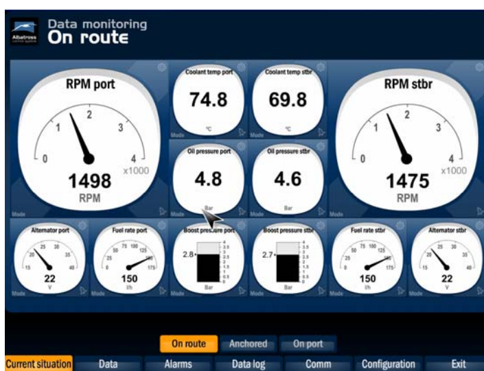
Fig 10: NMEA parameter monitoring
